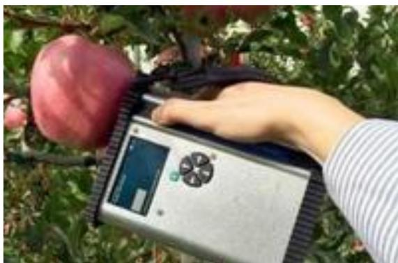
De fabrication américaine, ce spectromètre portable présente les caractéristiques suivantes : spectromètre Carl Zeiss MMS-1 ; gamme de mesure : 310-1100 nm, résolution spectrale : 8-13 nm, LCD visible à lumière solaire, batterie, enregistrement des données sur carte SD 4GB, poids de 1,05 kg. Le CTIFL a acheté cet équipement, et propose gracieusement sa mise à disposition dans le cadre du projet.
